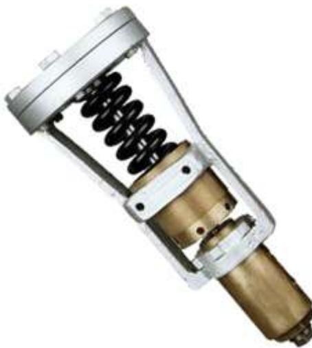
VÁLVULA PILOTO Série PI, para comando de atuadores pneumáticos nos mais diversos tipos de válvulas incorporada, de controle a distância. Este sistema mantém a pressão requerida no ponto de ajuste desejado, em diversos tipos de fluidos.
